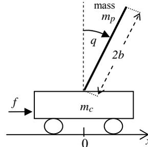
Fig. 6. Inverted Pendulum System.
