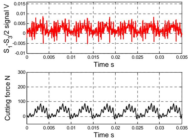
(d) Spindle speed: 12000 min<sup>-1</sup>
