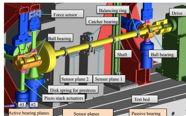
Fig. 2. Rotor test rig
