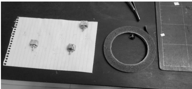
Fig 3: SEM prepared specimens
