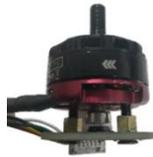
Fig. 4. Magnetic encoder module
